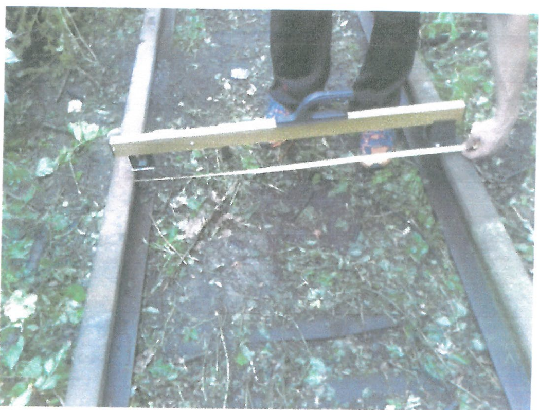
Rys. Poszerzenie +60mm(nieprzytwierdzony tor)
